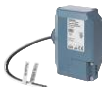
Fuente alimentación tipo JB de 80 mA 5WG1125-4CB23 Tipo: JB 125C23 Para montaje en el interior o anexadas a cajas de conexionado tipo UL/NEMA mediante conector roscado de 1/2". Tensión de alimentación de 120 V CA 50..60 Hz.
