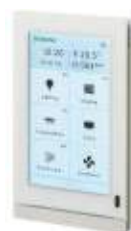
Pantalla Táctil 5WG1205-2AB22 Tipo: UP 205/22 Unidad de control ambiente TC5, color negro, con pantalla táctil de 5" capacitiva. IPS a color y de resolución de 480x854 píxeles. Montaje vertical y horizontal
