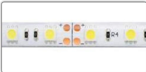
Led triple chip en tira continua epoxy cover transparente. de 5mts de longitud, con soporte de tira adhesiva de alta calidad. La tira permite ser cortada cada 50mm. (3 leds).
