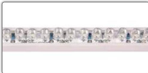
TIRA IP20. alta potencia de 600mm de longitud. Disponen de cableado por los dos extremos. Permite ser cortada cada 20mm. (3leds). Montada sobre perfil acrílico blanco.
