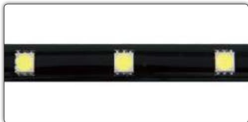
Led triple chip en tira continua con protector transparente de silicona de 300mm de longitud. La tira permite ser cortada cada 75mm (3 leds). No incluye soporte de banda adhesiva.
