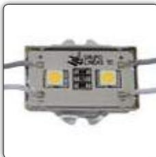
Placa LED para señalización, cada módulo incorpora 2 triple chip. Base del módulo en chapa de aluminio, sistema de fijación mediante tira adhesiva de doble cara. Permite también la fijación mediante tornillos. 10 placas unidas entre ellas por cable de 85mm de longitud. Máximo número de placas por fuente 20 unidades.
